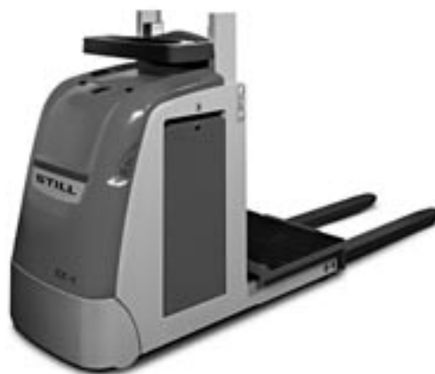
ЕК-Х с телескопической мачтой, габаритная высота 1500 мм
