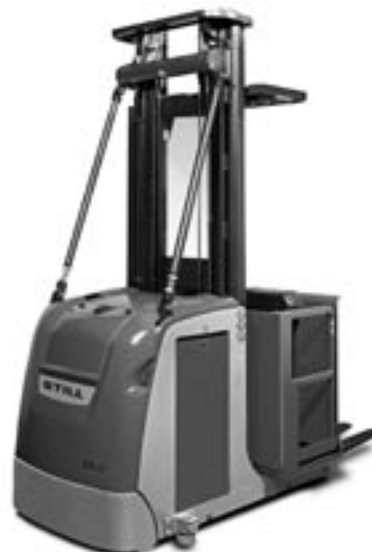
ЕК-Х с телескопической мачтой, габаритная высота 2400/2900 мм
