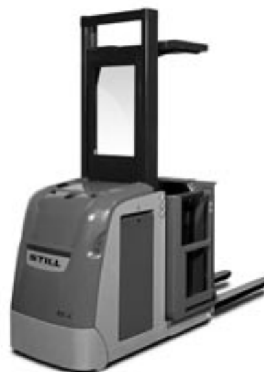
ЕК-Х с простой мачтой, габаритная высота 2000/2500 мм
