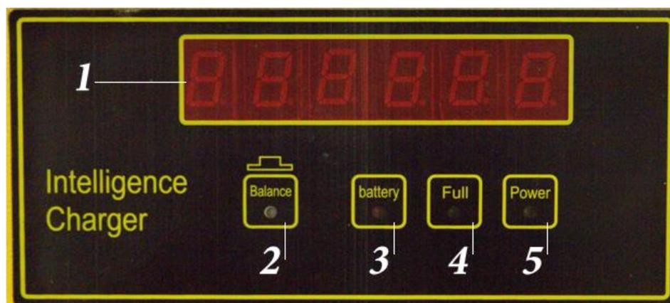
1. **Дисплей:** показывает процесс самодиагностики при включении, напряжение батареи, ток зарядки, емкость, время, окончание зарядки.
