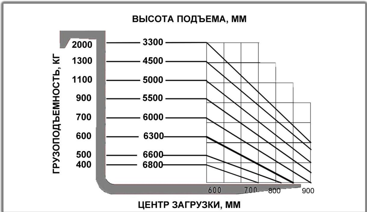
При загрузке руководствуйтесь графиком нагрузки на этикетке. Грузоподъемность штабелера зависит от высоты подъема и положения центра тяжести груза. Не допускайте перегруза.
