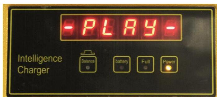
Во время зарядки горит индикация Battery, а на дисплее бегущей строкой отображается информация о напряжении аккумулятора в данный момент, токе, времени зарядки и уровня заряда в текущий момент.
