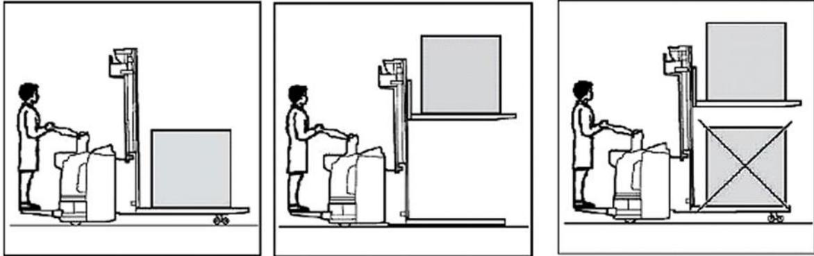
Включите штабелер. Подведите машину к месту погрузки. Кнопками подъема/опускания вил отрегулируйте необходимую высоту. Убедитесь, что груз на вилах распределен равномерно. Поднимите груз на требуемую высоту.
